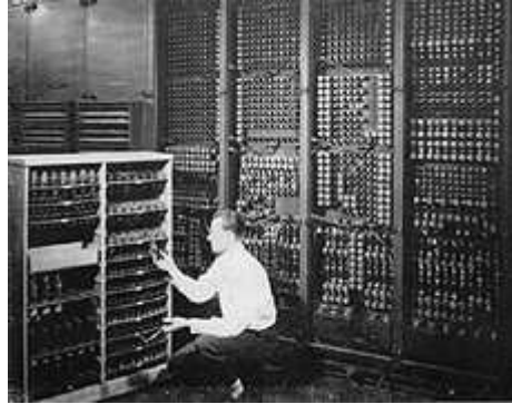
Fotografia 1. ENIAC - pierwsza maszyna licząca nazwana komputerem, skonstruowana w 1946 roku. Był to doprawdy cud techniki - przy poborze mocy równym zaledwie 130 kW mógł wykonać aż 5 tysięcy obliczeń na sekundę (ok. milion razy mniej niż współczesne komputery). (zdjęcie pochodzi z serwisu Internetowe Muzeum Starych Programów i Komputerów )
